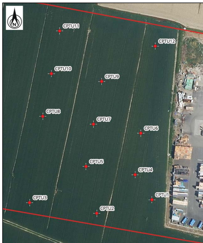
Figura 19: Ubicazione delle prove penetrometriche eseguite nel Novembre 2025.
